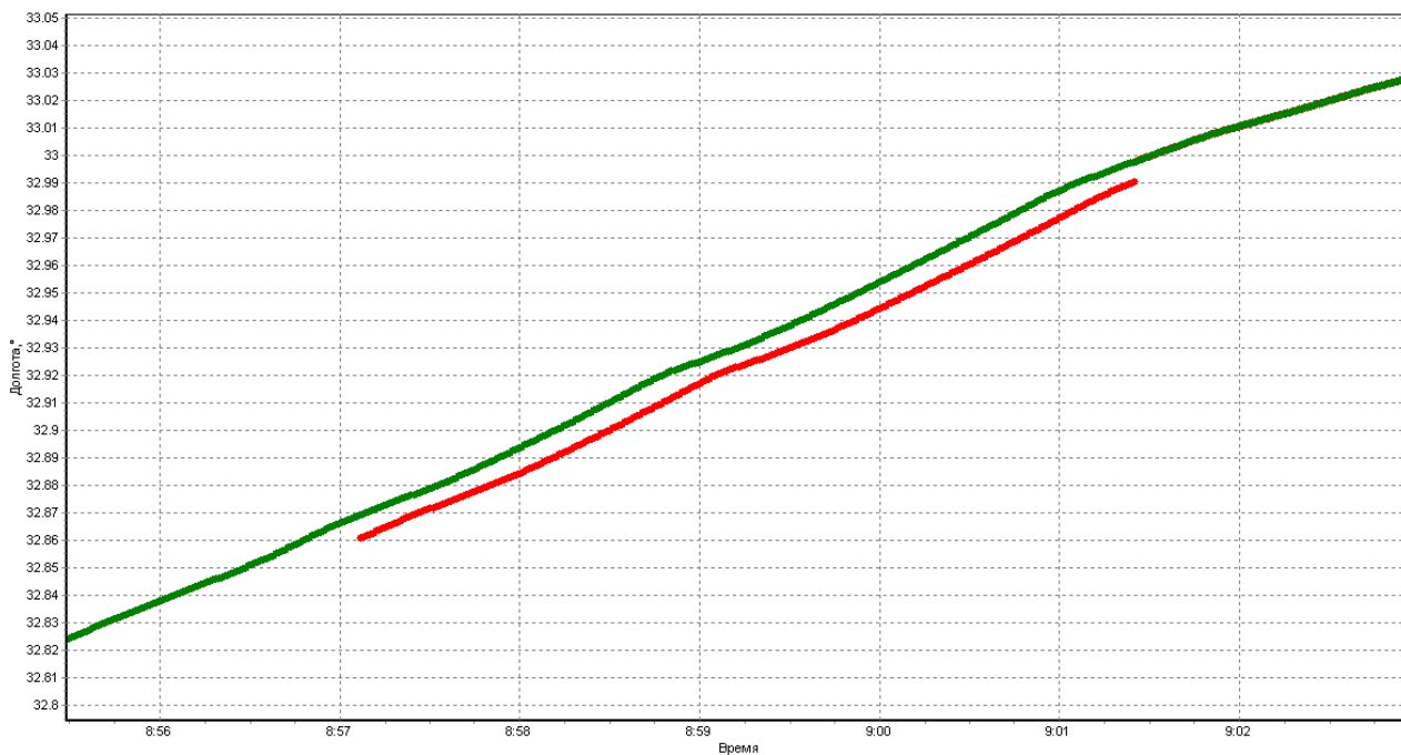
Рисунок 11 Фрагмент графика изменения долготы на участке 10. Зеленым – контрольная траектория. Красным - показания МНП-М9.1
