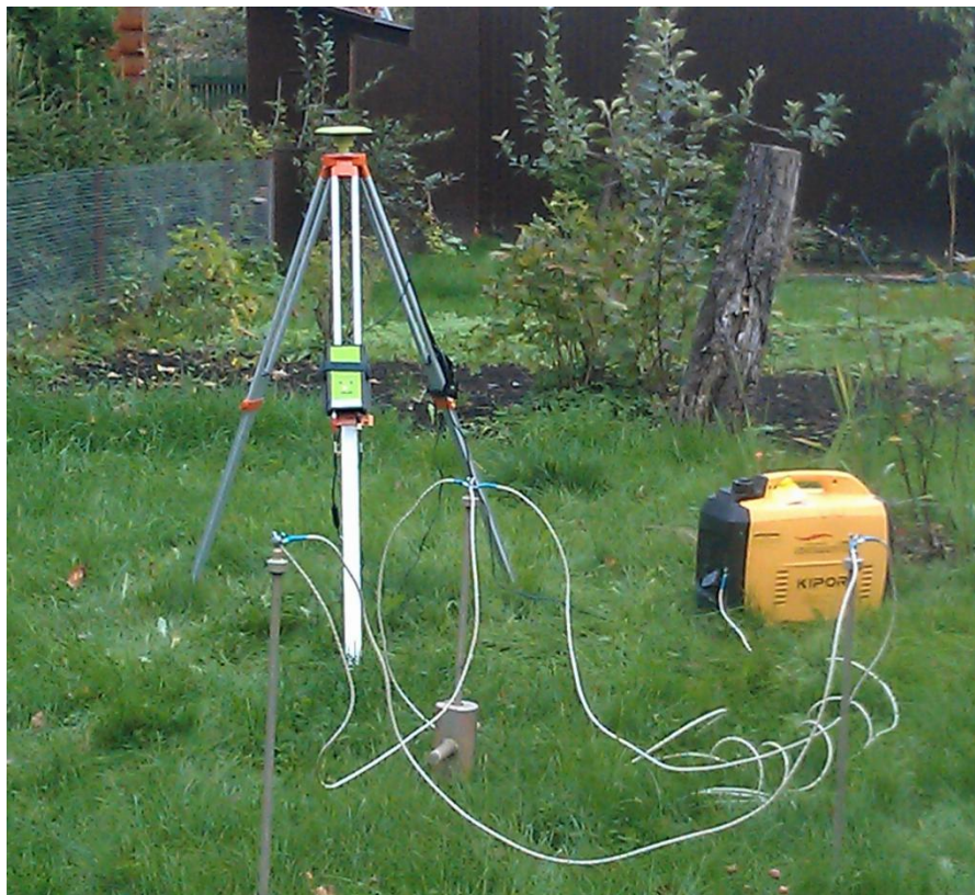
Рис. 1 Элементы временного базового пункта
