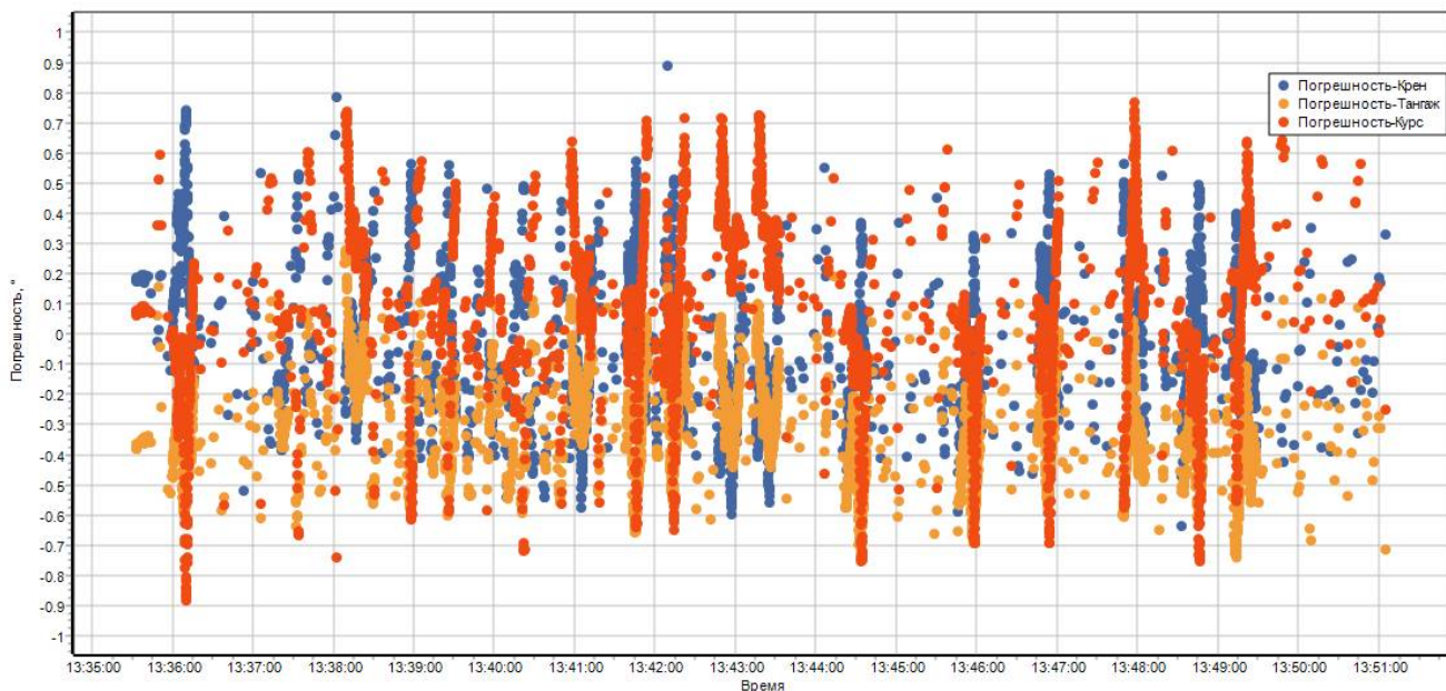
Рисунок 14 Тест №5. Невязки в автономном режиме
